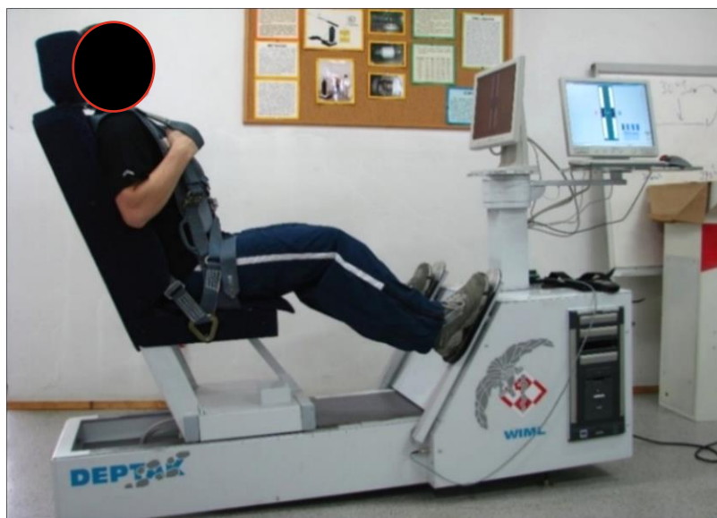
Ryc. 7. Symulator Anti-G Straining Maneuver (napinający manewr przeciwprzeciążeniowy) „Deptak”, konstrukcja Wojskowego Instytutu Medycyny Lotniczej
