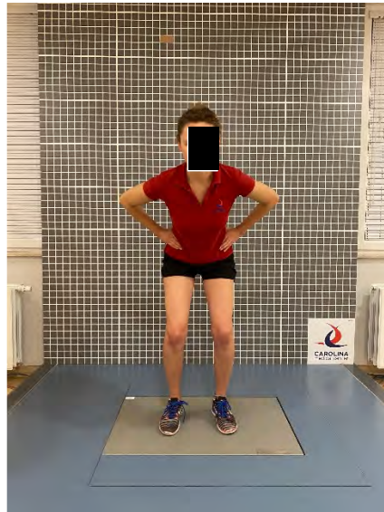
Ryc.23. Sposób pomiaru wysokości wyskoku ACMJ na platformie dynamometrycznej AMTI USA (opracowanie własne).
