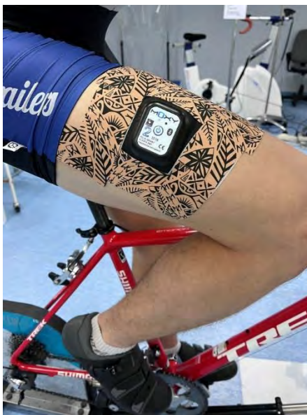
Fotografia 1. Sposób stabilizacji monitora Moxy na mięśniu obszernym bocznym.
